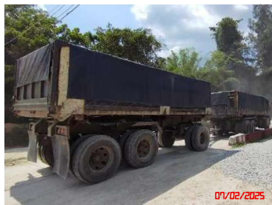
รูปที่ 13 การใช้ผ้าใบปิดคลุมรถบรรทุก
